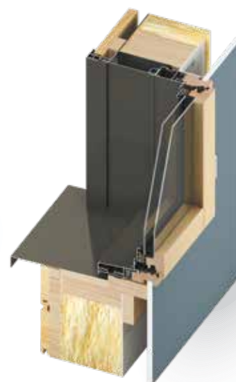
Adaptation pour mur ossature bois (HEMOB)
